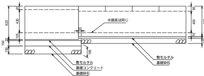
1. 道路側溝横断の施工断面では、基礎コンクリートを100mm、基礎砕石を150mm打設する為、均し面を深く掘る必要がある。
