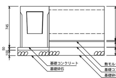
1. 自社の道路側溝用柵を使用すると、製品幅が同じなので、施工がしやすい。
