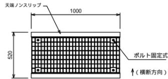
1. 落ちふた式U形側溝を車が横断する場合に使用する。
