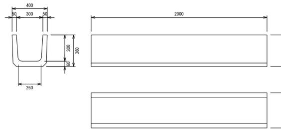
上ぶた式U形側溝 (2m) 断面図 S=1/20
