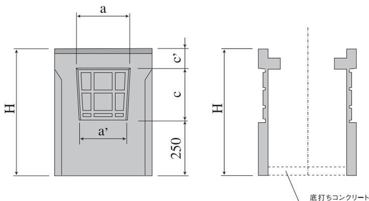
1. 落ちふた式U形側溝 (JIS A 5372)に合わせたサイズが使用可能。
