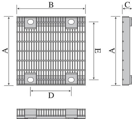
道路側溝用柵グレーチング 寸法・重量表
