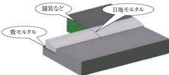
乗入用は、設置の際に目地モルタルや敷モルタル、アスファルト舗装などでしっかりと固定してください。固定が不十分な場合には、車両の通行によって割れや欠損が生じる場合があります。
