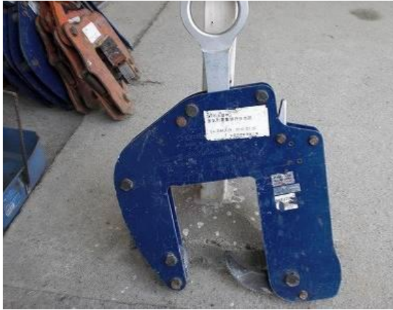
バイコンクランプ(最大容量1250kg)
