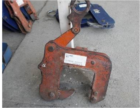
バイコンクランプ(最大容量600kg)
