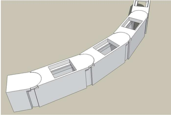
道路設計において、カーブやコーナー部分、交差点の巻き込み部分の側溝の処理方法は、以前から問題として上がっていました。施工業者としても、本来必要のない製品のカットや型枠組立作業が発生し、施工性の低下を引き起こしていました。そこで、これらを解決するために「フレキシブル側溝」が開発されました。
